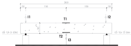
a) Sơ đồ bố trí thiết bị đo các số liệu thí nghiệm
