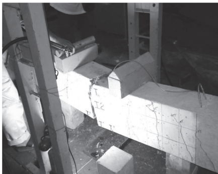
Hình 7 - Sự phá hoại của dầm BT cốt GFRP có hàm lượng cốt thấp
