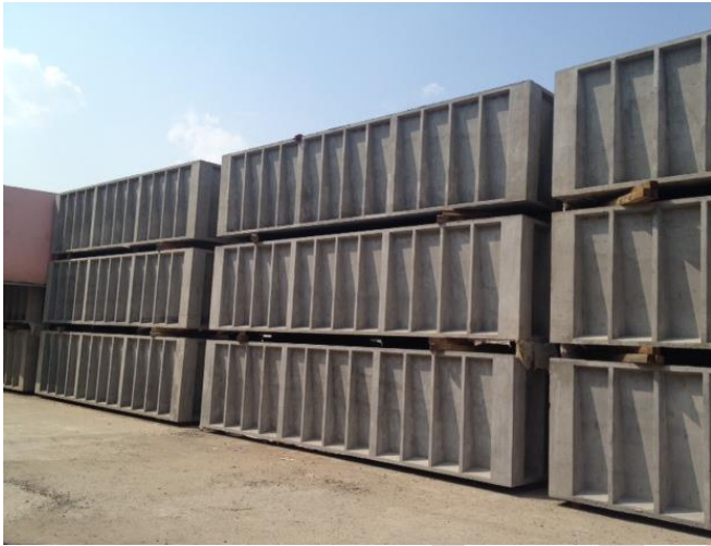
Hình 4-9: Thùng chìm dạng container do Công ty Hoàng Lê sản xuất.
