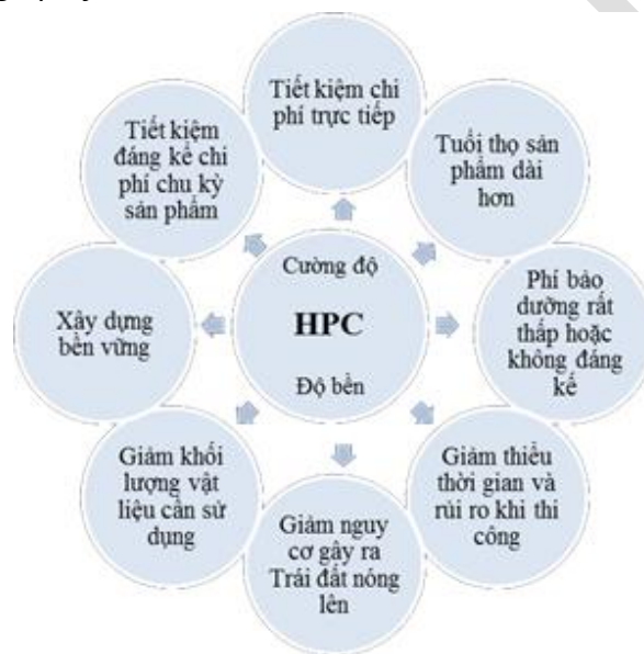
Hình 4-5: Đặc tính bê tông HPC.
