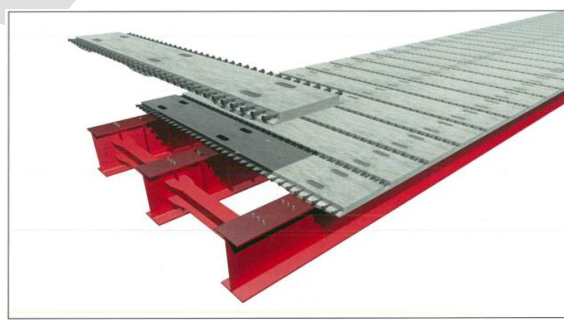
Hình 23: Cấu kiện bản mặt cầu.
