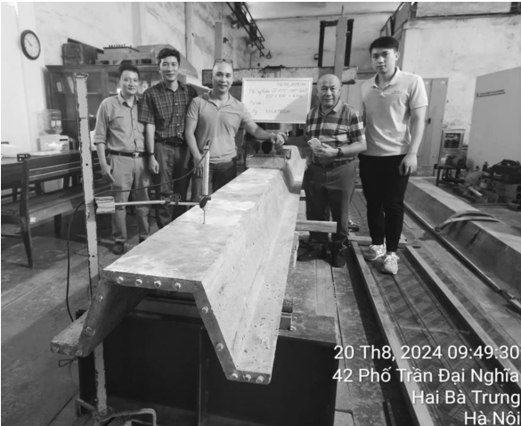
Hình 10: Thí nghiệm chịu tải cọc ván cừ bê tông cốt FRP ứng lực trước
