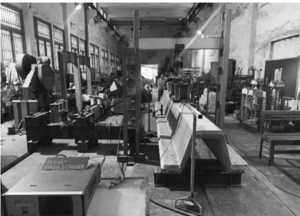
Hình 12: Thí nghiệm loại cừ bê tông cốt GFRP kích thước 996 x 530 mm dài 6m tại phòng LAB 125 – ĐHXD Hà Nội
