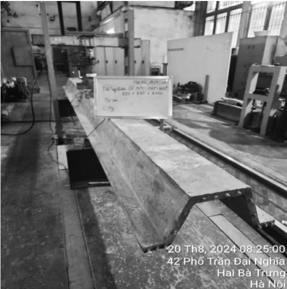
Hình 11: Thí nghiệm loại cừ bê tông cốt GFRP kích thước 550 x 350 mm dài 6m tại phòng LAB 125-ĐHXD Hà Nội
