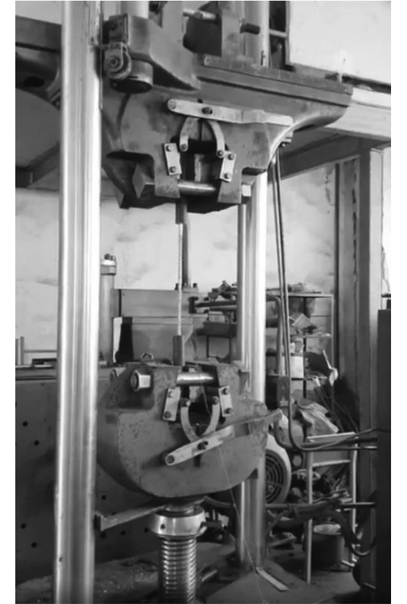
Hình 13: Thí nghiệm xác định cường độ chịu kéo của cốt GFRP
