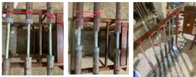
a) - Gắn cảm biến biến dạng và dây dẫn cảm biến cho thí nghiệm mô-đun đàn hồi của GFRP D13 b) - Gắn cảm biến biến dạng và dây dẫn cảm biến cho thí nghiệm mô-đun đàn hồi của GFRP D19 c) - Quá trình gắn cảm biến biến dạng cho thí nghiệm kéo GFRP
