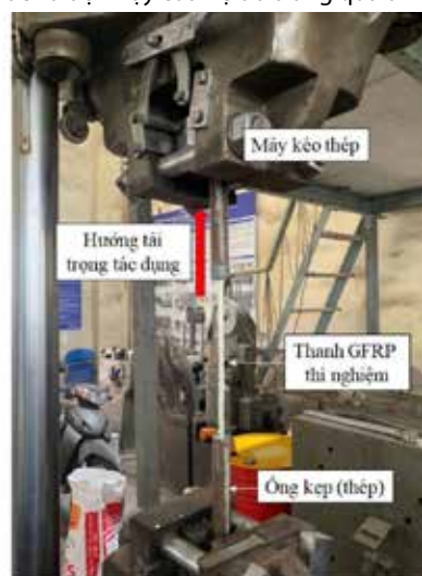
a) - Thí nghiệm xác định cường độ chịu kéo GFRP
